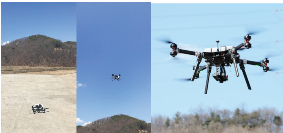
회전의 무인항공기 촬영(준비→이륙→촬영(모니터링))
